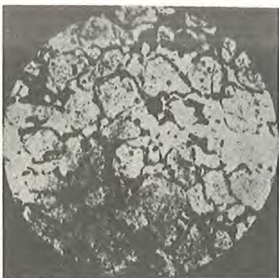
Kemikalie injiceret sand. 15× forstørrelse i polarisationsmikroskop. Kvartskornene er let skyggede. Kiselgelys-gelen er mørkt farvet ved hjælp af Methylenblåt. Luftporerne er hvide.
