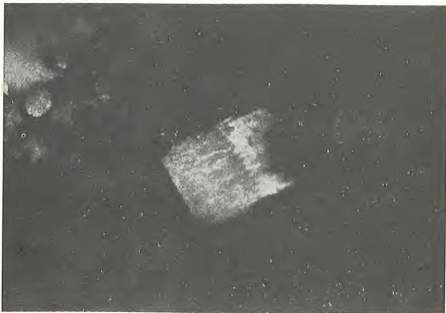
Fig. 6. Rhombisk krystal af calcit udfældet i hulrum i beton, udstøbt med hydraulisk kalk som bindemiddel i en mole ved Port d'Antibes, Sydfrankrig, omkring 1650—1700. Betonen har siden været udsat for påvirkning af havvand men har holdt sig godt. Forstørrelse 500 gange. Foto Ervin Poulsen.
