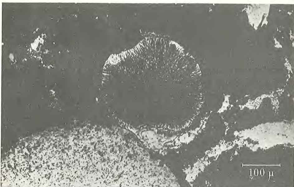
Fig. 7. Formation af nåleformede kalciumaluminatsulfatkrystaller i hulrum i samme beton som omtalt i fig. 5. Det er karakteristisk, at krystallerne ikke udfylder hulrummet og ojen-synligt ikke har udøvet den i litteraturen ofte angivne sprængende virkning på omgivende cementpasta. Fra (57 I 4).
