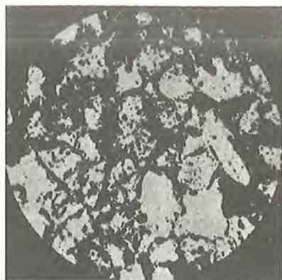
Nat. Osningsandsten 110× forstørrelse i polarisationsmikroskop. Kvartskornene er let skyggede, omgivet af kiselgelysholdigt bindemiddel, der er farvet af den i stenen forekommende naturlige jernhydroxyd.
