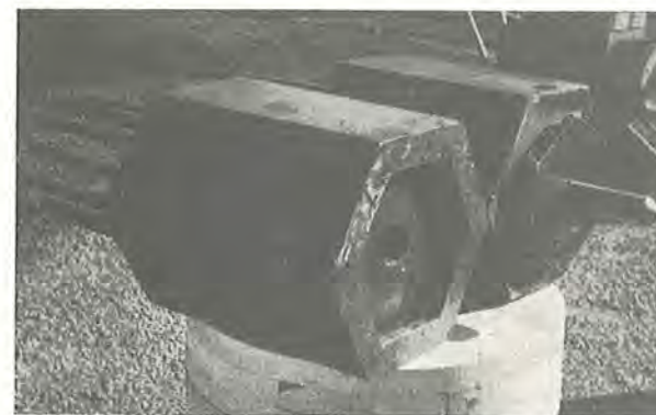
Fig. 6. Pælesko til samling af Herkules-pælens elementer
